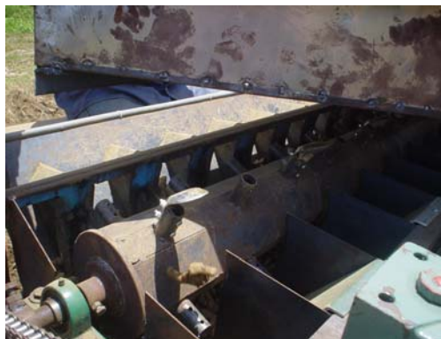
รูปที่ 4 แสดงการตกของหัวกระชาย/ขมิ้นชันกำลังตกลงในช่องทางนำหัวกระชาย/ขมิ้นชันลงในร่องที่เปิดไว้ที่พื้นดิน
